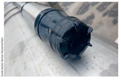
Abb. 8: Beispieldatensatz einer Überbelüftung des Belebungsbeckens durch eine verschmutzte Sauerstoffsonde (oben), Foto einer Sauerstoffsonde (unten)
