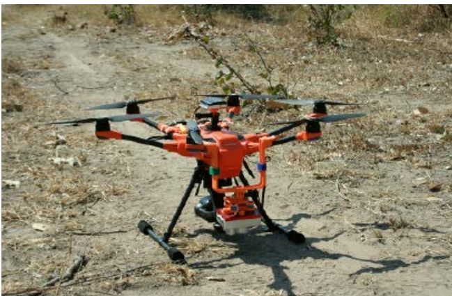
Abb. 6: Drohne mit 5-Kanalsensor zur Aufnahme von Vegetations- und Algenindizes
