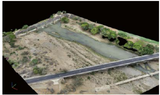
Abb. 10: Digitales Oberflächenmodell des Olifants River (Südafrika) am Pegel Oxford mit Korrekturbedarf (Schwarze Lücken)
