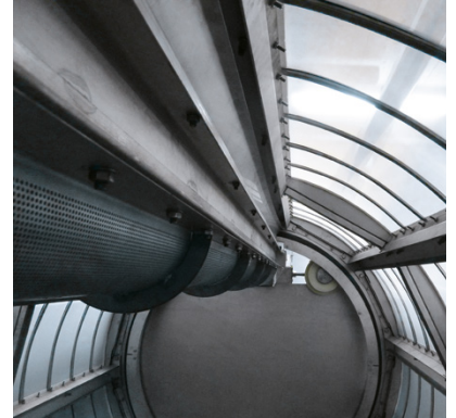
horizontal gelagerte Siebtrommel und interne Seihzone (hier als Lochblech)
