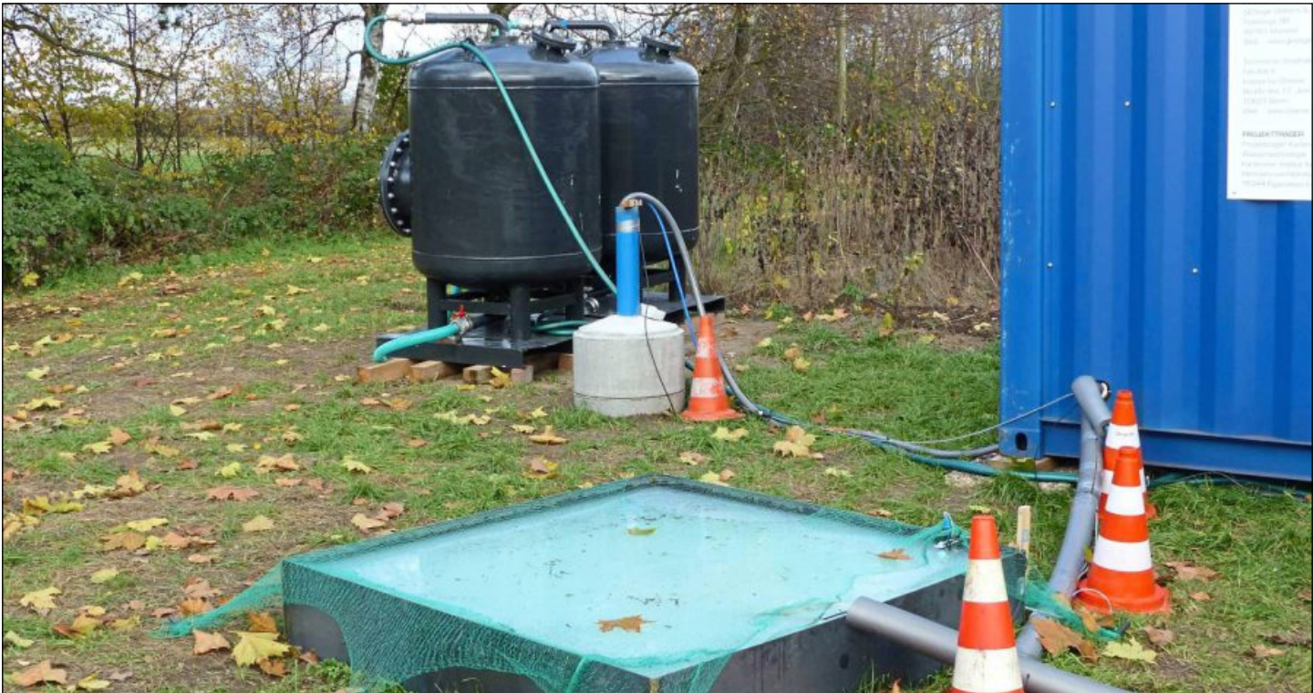
DIE MILCHIGE BIOPOLYMER-LÖSUNG im Becken ist der Schlüssel beim Feldversuch in Hügelsheim. Sie löst PFC von den Bodenpartikeln und transportiert sie ins Grundwasser. Das PFC-Grundwasser wird aufgefangen und gesondert entsorgt. Archivfoto: Klatt
